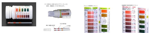
冷却水につけるだけでクーラントの沸点、凝固点、pHが分かります
