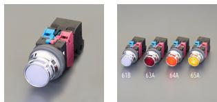
押ボタンスイッチは、基板上の切替スイッチとして組み込まれることが主な用途で、多種多様なものが存在します。またスイッチには二通りの動作の種類があり、一度押すとオンになり二度押すとオフになるタイプを「オルタネイト」、押している時のみオンになるタイプを「モメンタリ」と呼びます。
