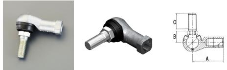
カタログ訂正 25/05/30 寸法図の値訂正 (誤)B:11.3mm C:13mm (正)B:10mm C:8mm (No.56 1115)
