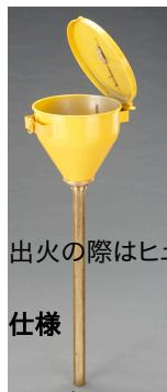
出火の際はヒュージブルリンクが74°Cで溶けて、ふたが自動で閉まります
